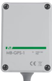
Le transmetteur dans une boîte spéciale en plastique, connecté à travers un presse-étoupe PG7 par un câble rond de longueur maxi  $\varnothing 7$  (p.ex. 2x0,5 mm<sup>2</sup>). La boîte avec bride d'étanchéité spéciale, fixée au support avec deux vis, fermée par couvercle à quatre vis avec un joint en silicone.
